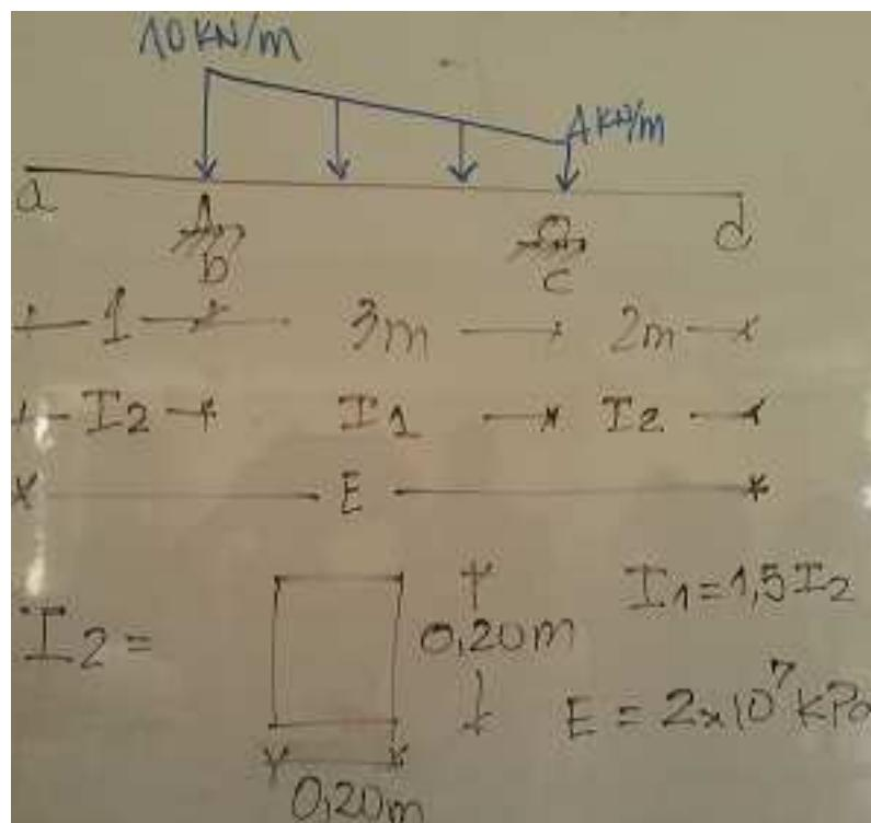
Usando el método del Área del Diagrama de Momento Flector, encontrar ángulos entre las tangentes y distancias entre tangentes y la curva elástica
