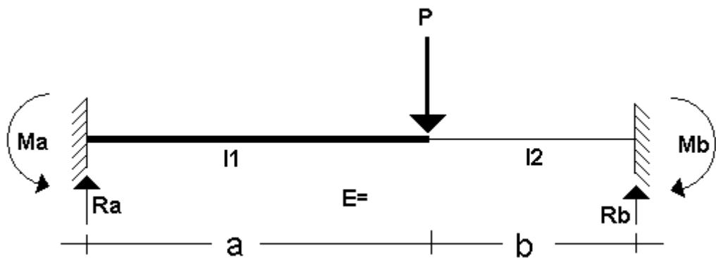
Cálculo de los momentos de empotramiento y las reacciones de la viga de la figura utilizando el método del Área del Diagrama de Momento Flector para el cálculo de giros y deflexiones
