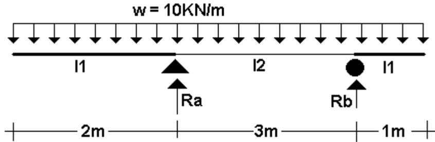
Cálculo el ángulo entre las tangentes a la curva elástica de los puntos a y b y la distancia entre la proyección de la tangente del punto a con el punto b después de aplicada la carga utilizando el método del Área del Diagrama de Momento Flector
