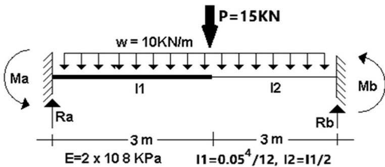
Cálculo de los momentos de empotramiento y las reacciones de la viga de la figura utilizando el método del Área del Diagrama de Momento Flector para el cálculo de giros y deflexiones
